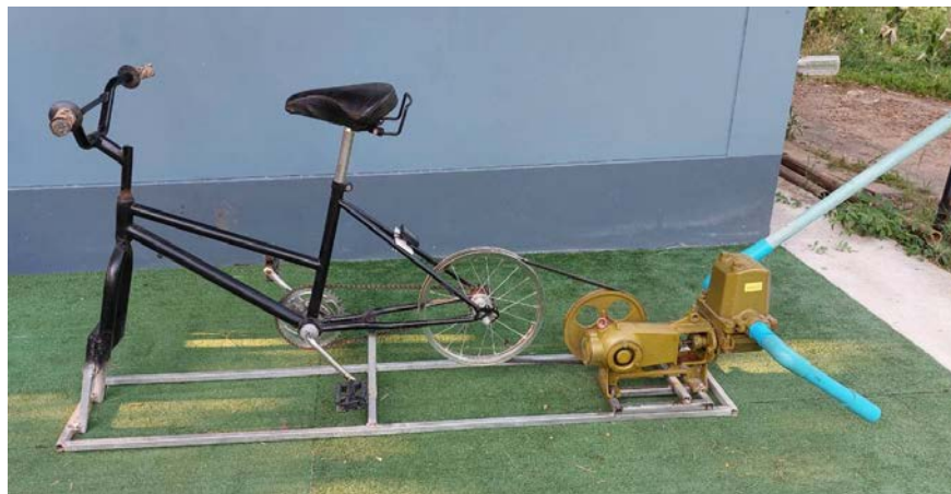
ภาพที่ 2 จักรยานออกกำลังกายเพื่อบำบัดน้ำเสียแบบเติมอากาศที่เสร็จสมบูรณ์
