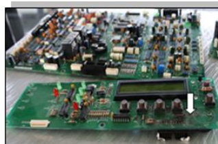
รูปที่ 4 ความเสียหายจากฟ้าผ่าต่อแผงเมนบอร์ดของอินเวอร์เตอร์
