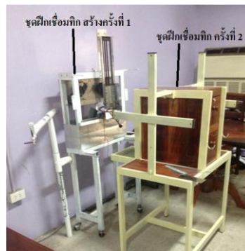
รูปที่ 1 แสดงชุดฝึกเชื่อมทิกที่ผู้วิจัยสร้างขึ้น 2 ครั้ง
