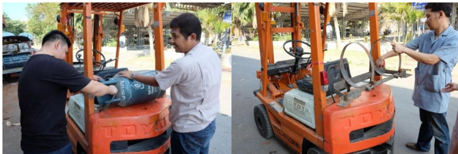
รูปที่ 4 การทดลองการใช้ก๊าซชีวภาพและดำเนินการติดตั้งที่วางถังก๊าซ
