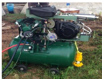
รูปที่ 2 แบบชุดบรรจุก๊าซชีวภาพโดยใช้เครื่องยนต์เบนซินขนาด แรงม้า 5.5
